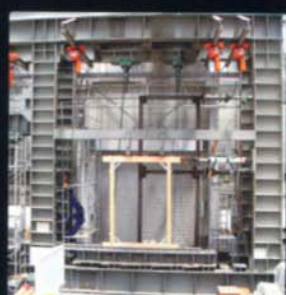
【※2】近畿職業能力開発大学校で行われた各種「面内せん断試験」の様子
